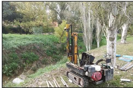
Fotografia 3. Vista de la màquina utilitzada per a la realització d'un dels assaigs de penetració dinàmica DPSH.
