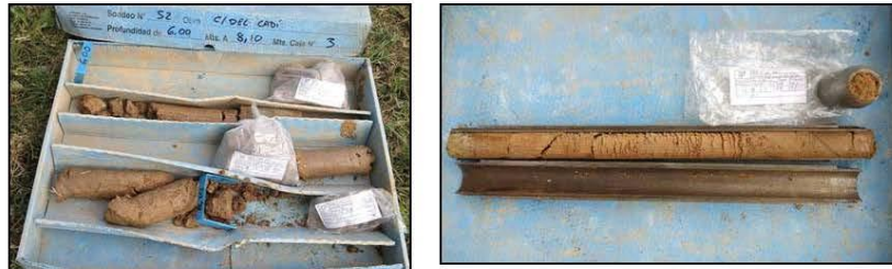
Fotografia 8 i 9 . Detall dels materials del segon nivell tal i com es recuperen en un dels sondeigs realitzats i en l'assaig SPT.
