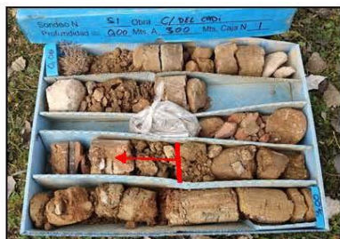
Fotografia 4 i 5 . Detall dels materials de rebliment antròpic tal i com es recuperen en els dos sondeigs realitzats.
