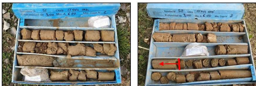
Fotografia 6 i 7 . Detall dels materials del primer nivell tal i com es recuperen en els dos sondeigs realitzats.
