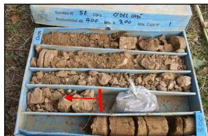
Fotografia 4 i 5 . Detall dels materials de rebliment antròpic tal i com es recuperen en els dos sondeigs realitzats.
