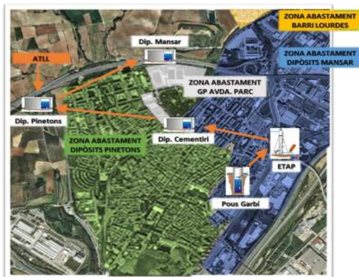
Figura 3. Esquema de la xarxa d'abastament d'aigua de Mollet del Vallès (2)
