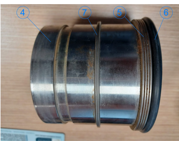
DETALL CONNEXIÓ PORT D'UNIÓ
