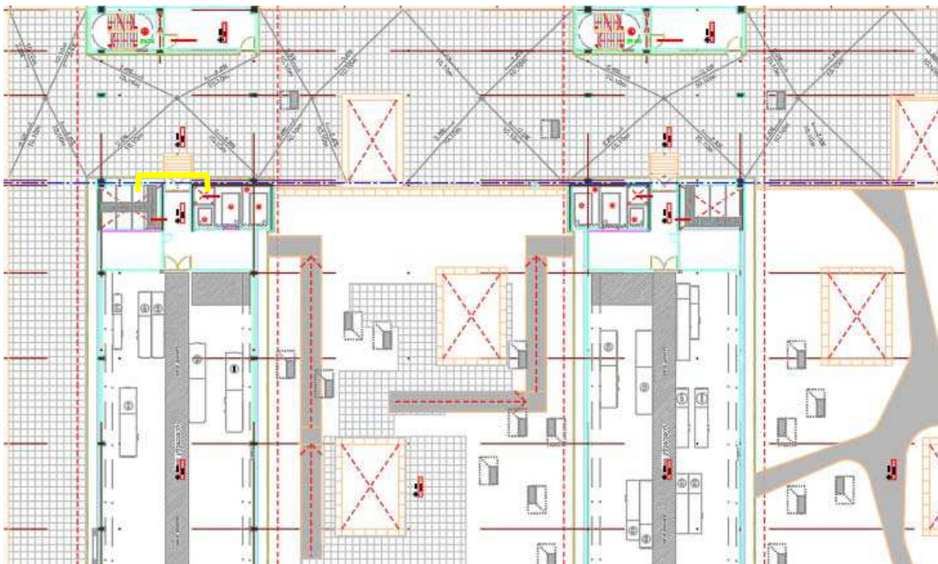
Imatge 54. Pas de cablejat en groc a planta tècnica de un baixant a l'altre Espina A
