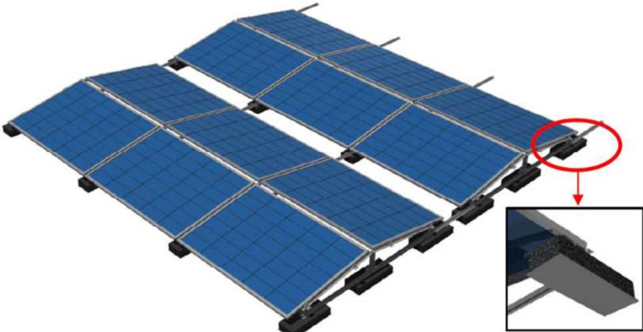
Imatge 33. Detall vista 3D del conjunt i detall EPDM
