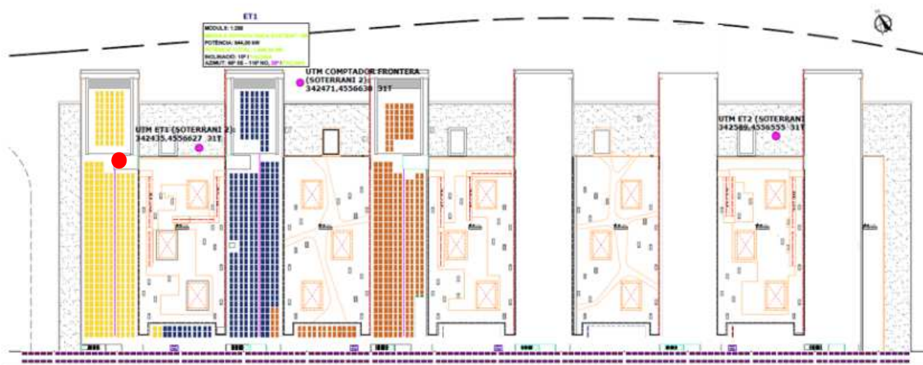
Imatge 48. Mòduls fotovoltaics connectats a la ET1
