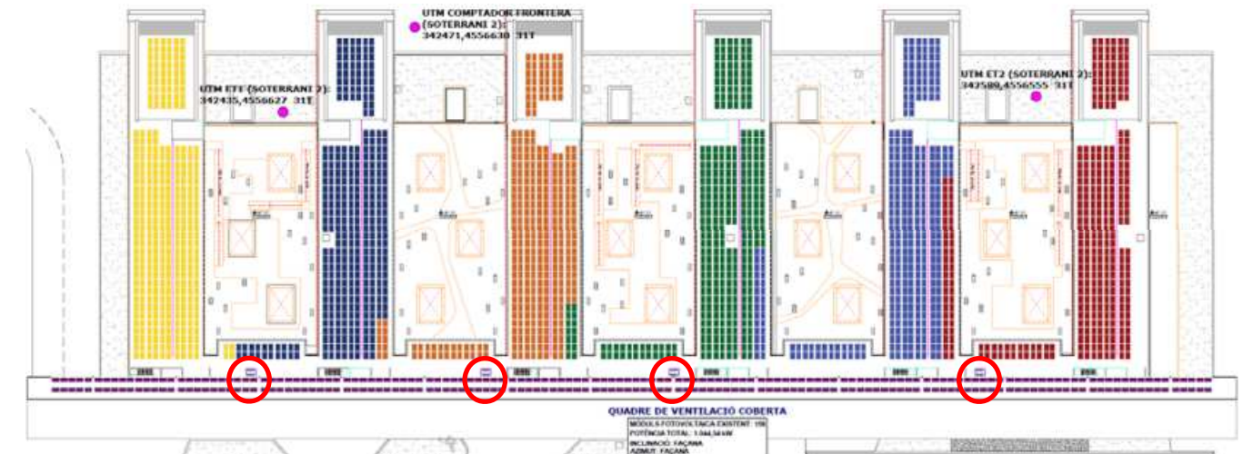
Imatge 78. Localització inversors de 6 kW a coberta
