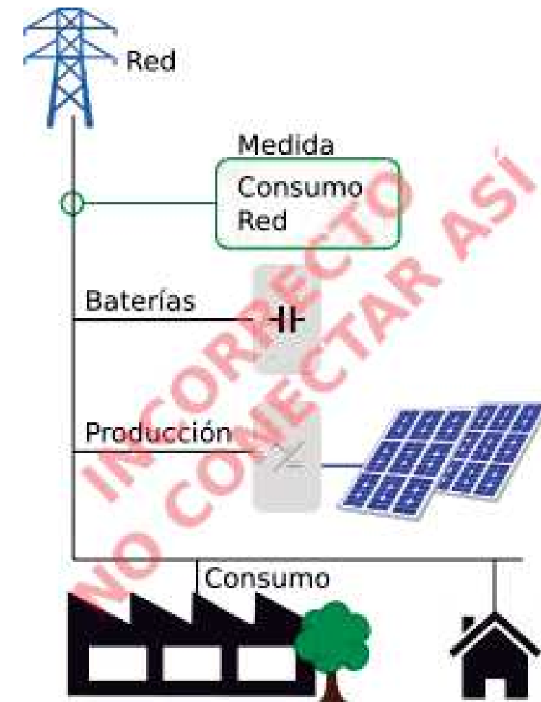
Figura 6: Esquema INCORRECTO conexión baterías
