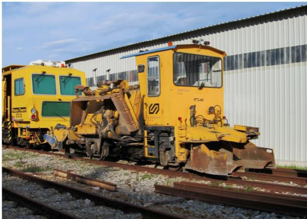
La perfiladora 275.01 a Manresa Alta. Foto J. C. Salmeron (2012).
