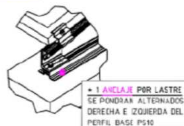
DETALLE A (N/E) NUDO DELANTERO PRIMER SOPORTE ENRASADO CON EL PERFIL BASE PS10
