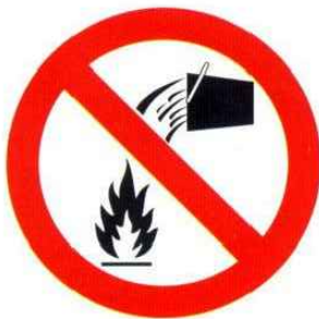
PROHIBIT APAGAR AMB AIGUA
