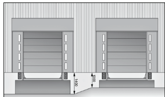
Figura 11. Tolva de carga escalonada.
