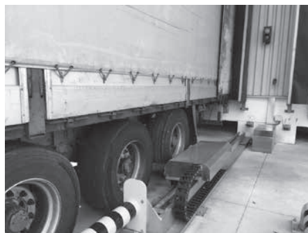
Figura 27. Sistema que automatiza todo el proceso de aproximación al muelle.
