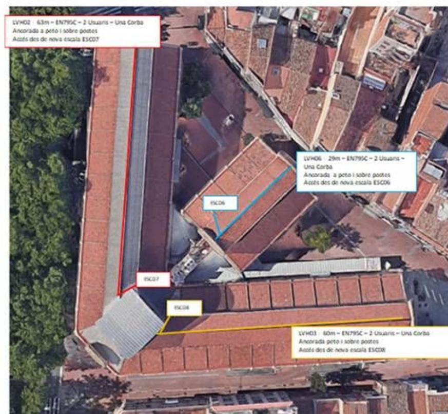
Fig.15 . Detall de la proposta de noves les línies a les cobertes superiors
