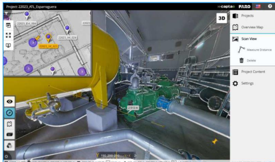
Imatge 9. Mostrem a la imatge superior a on s'ha pres dades amb l'equip de làser escàner 3D, sempre amb cura de que no hi hagi zones d'ombra en la presa de dades.
