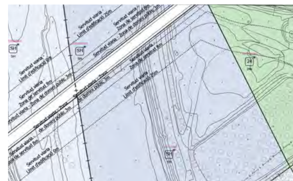
Figura 3: Servituds viàries existents
