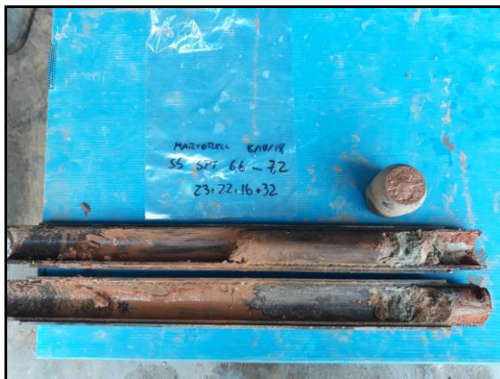
Foto 13: Sondeig S-5, SPT a 6,6 metres.
