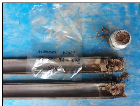
Foto 12: Sondeig S-5, SPT a 3,6 metres.
