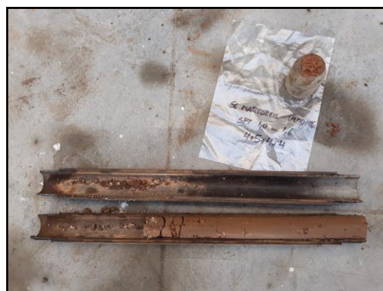
Foto 18: Sondeig S-6, SPT a 1,0 metres.
