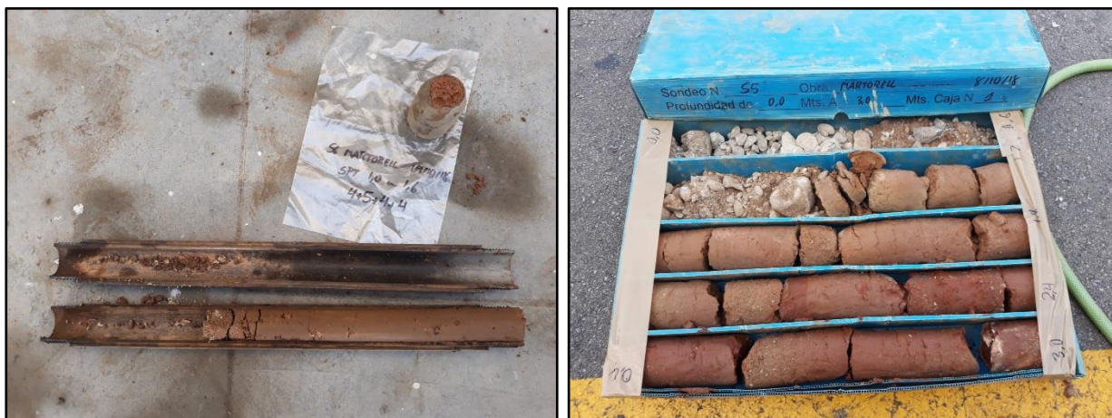
Aspecte dels materials de la capa B recuperats a l'assaig SPT i en caixes de testimoni.
