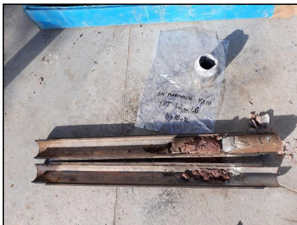
Aspecte dels materials de la capa R recuperats a l'assaig SPT.
