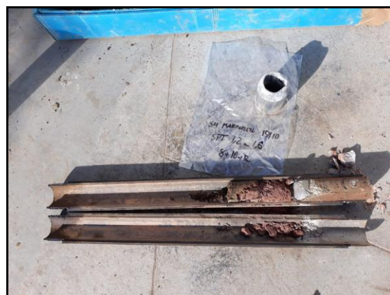
Foto 6: Sondeig S-4, SPT a 1,2 metres.
