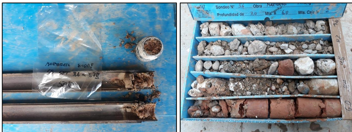
Aspecte dels materials de la capa C recuperats a l'assaig SPT i en caixes de testimoni.
