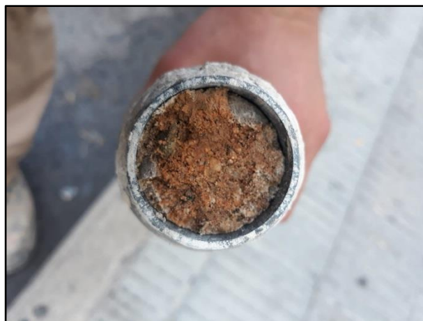
Aspecte dels materials de la capa R recuperats a l'assaig SPT.
