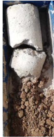
Foto 2. Nivell P. Paviment de formigó + subbase granular. Sondeig S-1 de 0,00 a 0,30 metres de fondària.
