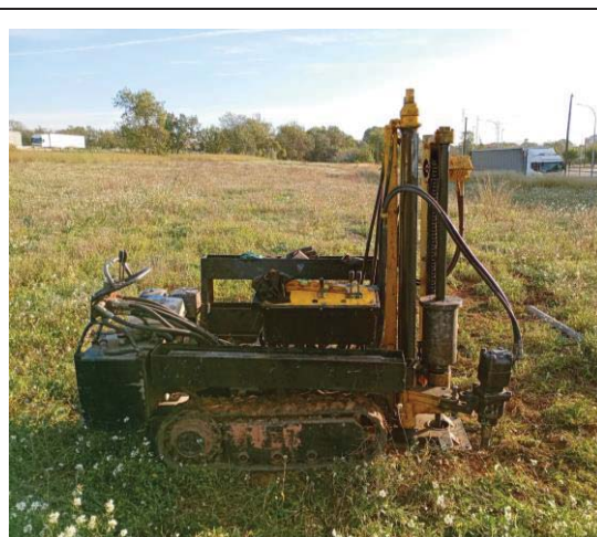
Penetròmetre Rolatec ML-76
