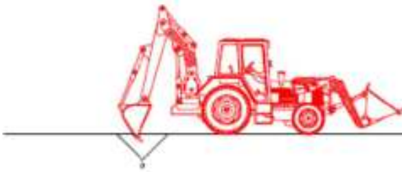
1. Buidat de terres amb retro-excavadora
