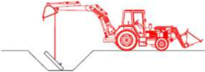
3. Col·locació de la base del pou
