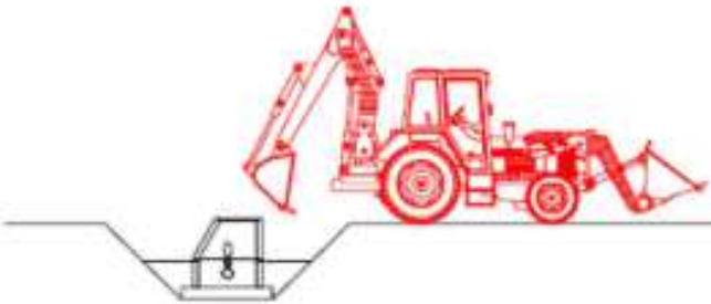
6. Reblert del pou amb retro-excavadora en tongades
