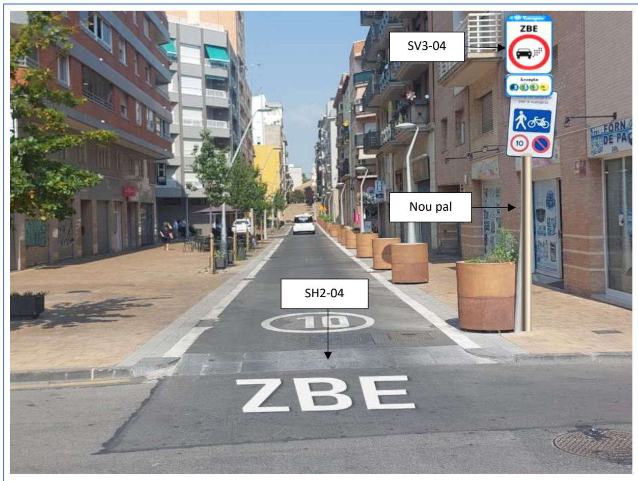
Il·lustració 17: Vista alçada d'ubicació de la senyalització d'entrada de la ZBE04-PdC05
