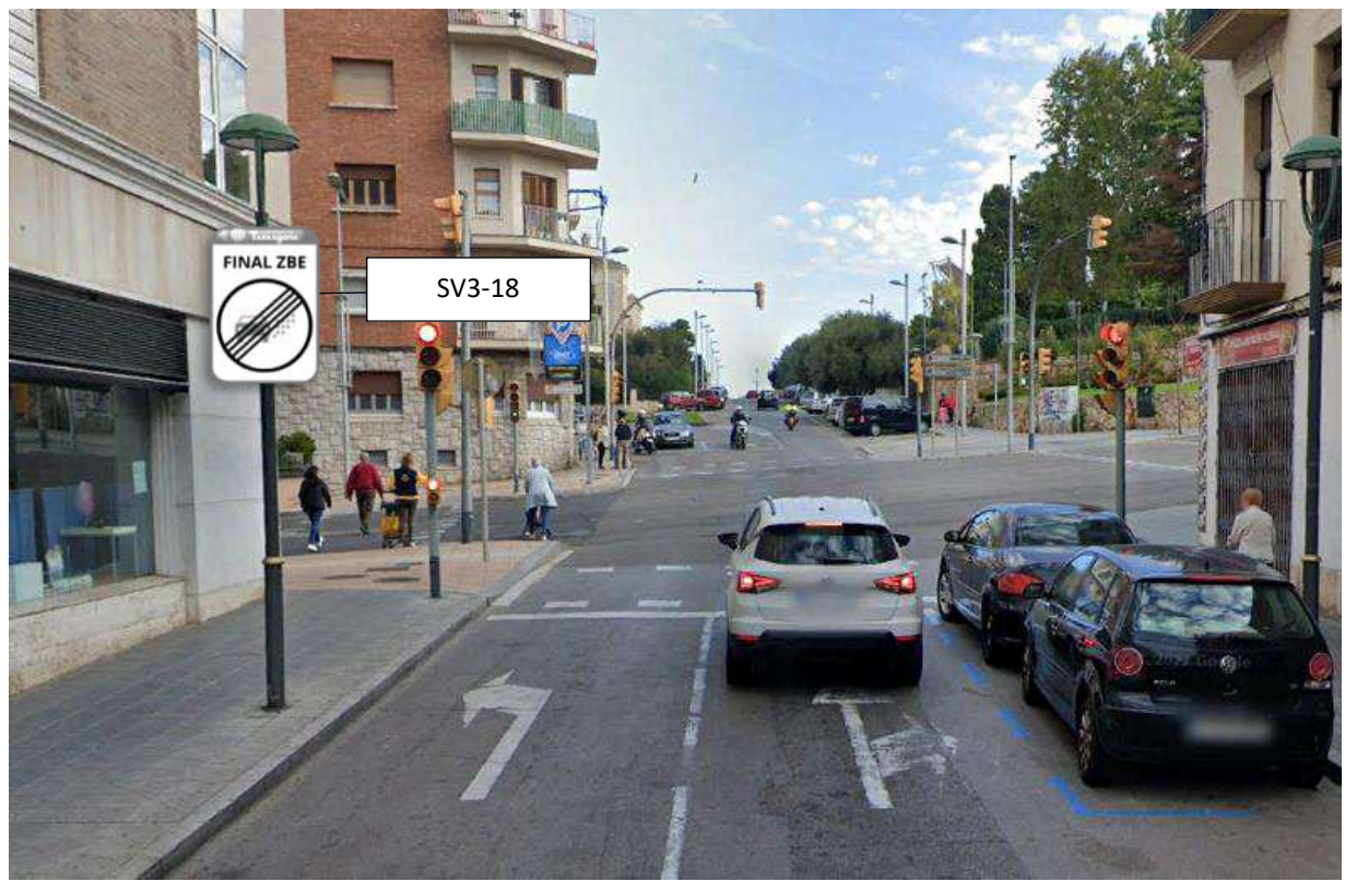
Il·lustració 72: Vista alçada d'ubicació de la senyalització de sortida de la ZBE-18
