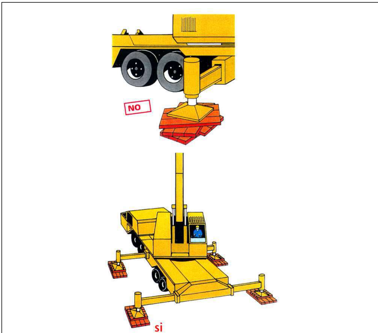
Col·locació estabilitzadors recolçaments
