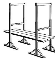
Fig. 1 b: Andami de borriquetas verticales
