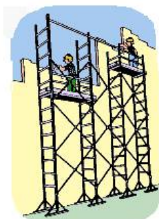
Fig. 2: Andamio amb arriostraments
