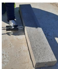
Figura 4. Ensayo para la determinación del coeficiente de fricción estático.
