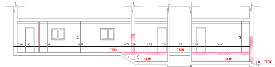
SECCIÓ ENDERROCS-OBRA NOVA 1:200
