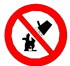
PROHIBIT APAGAR AMB AIGUA
