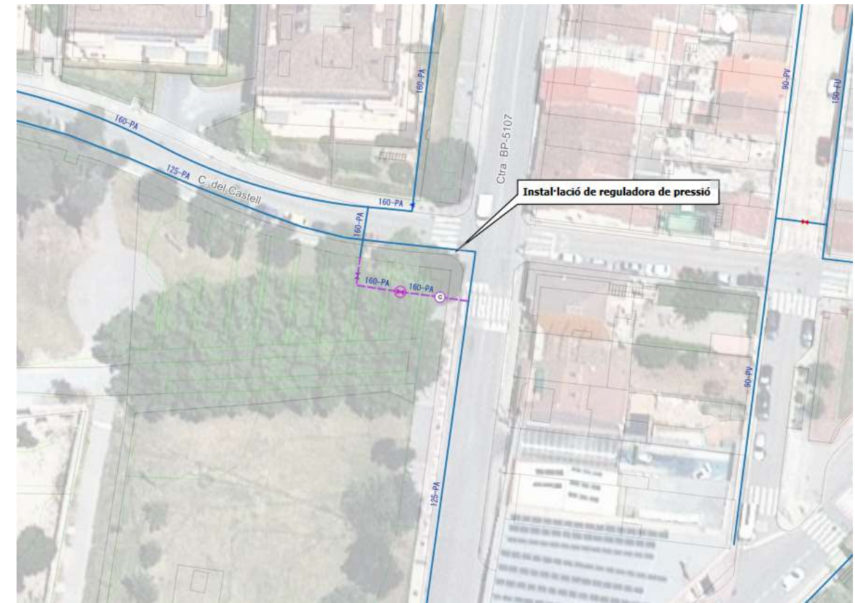
Figura 9. By pass amb reguladora de pressió i cabalímetre (carrer Castell)
