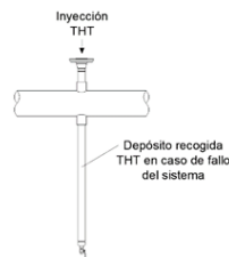
Detalle posición punto de inyección
