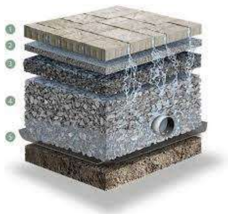
Figura 51. Esquema de implementació de pavimentació permeable
