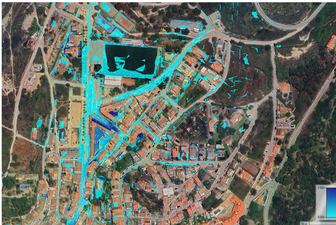
Figura 40. Comportament flux zona centre conca Torrent Escletxa
