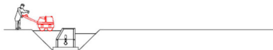
7. Compactació de terres al voltant del pou
