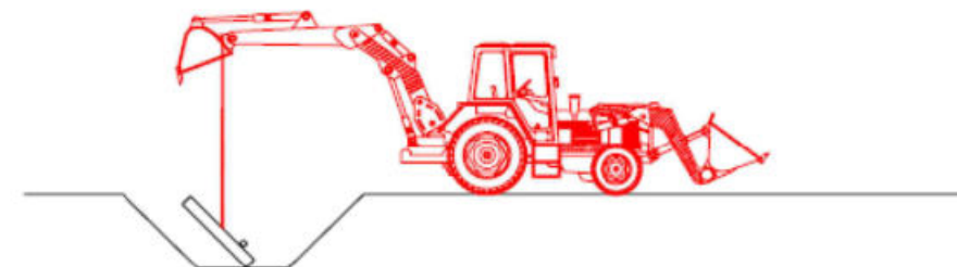
3. Col·locació de la base del pou
