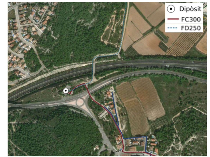
Figura 4. Vista de les connexions del dipòsit de la Masia de la Font.
