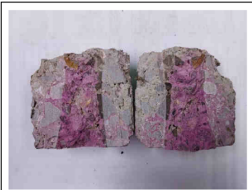
Detall carbonatació zona externa
