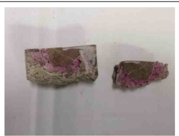
Detall carbonatació zona interna
