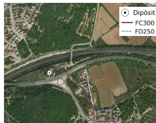
Figura 4. Vista de les connexions del dipòsit de la Masia de la Font.
