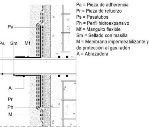
Fig. 9. Paso de conducto con manguito. Impermeabilización.
