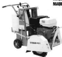
CORTADORA JUNTA DE DILATACIÓN
