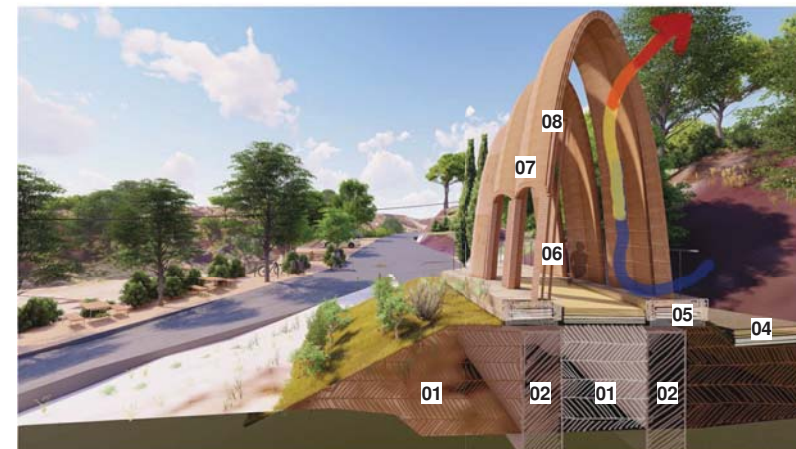
01 Terraplè de terra 02 Fonamentació volta 04 Paviment de sauló sòlid amb pols ceràmica 05 Sòcol de Fet de terra sobre formigó 06 Pilaret en T d'obra vista 07 Dintell de volta 08 Volta en forma de catenària
