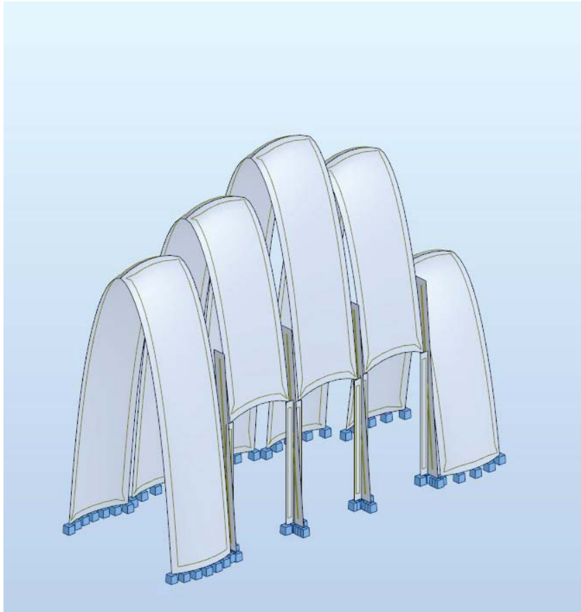
Fig1. Modelat d'elements finits de les voltes
