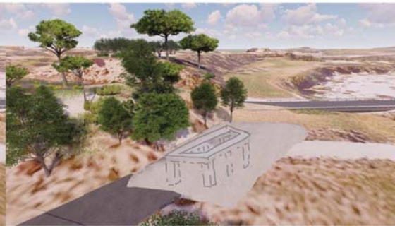
03 FONAMENTACIÓ Excavació i execució dels 6 pous de fonamentació Execució de les ríostres.
