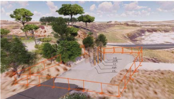
05 REPLANTEIG VOLTES El cindri és únic per les 5 voltes, donat que totes les voltes són iguals però de diferent alçada. S'ha d'executar, doncs, primer la més alta i en ordre decreixent per anar escurçant el cindri
