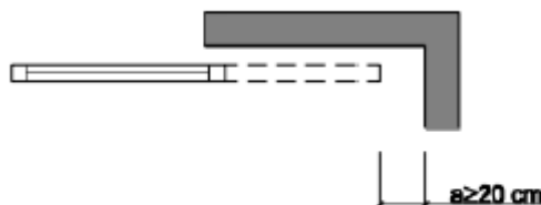
Figura 2.1 Holgura para evitar atrapamientos
