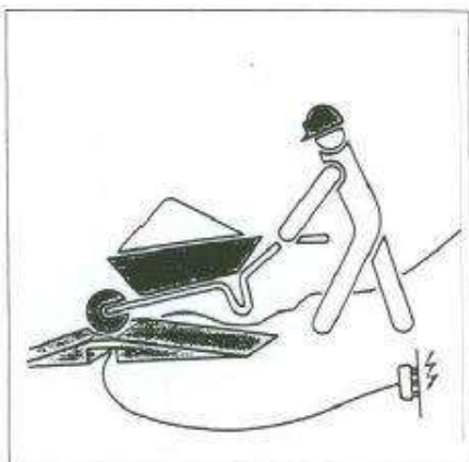
PROTECCION DE CABLES ELECTRICOS
