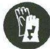
USO GUANTES DIELECTRICOS
