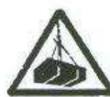
RIESGO CARGAS SUSPENDIDAS
