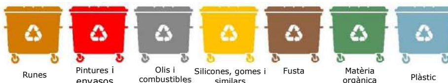
Figura 5: fraccions en les que ens comprometem a recollir i classificar els residus de l'obra
