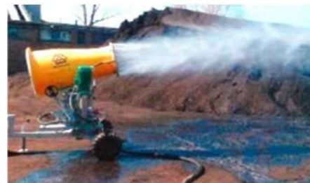
Figura 13. Canó nebulitzador per reducció de soroll i contaminació
