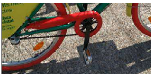
Imatge 11: Conjunt d'elements: protector integral de cadena amb elements d'ancoratge al quadre
