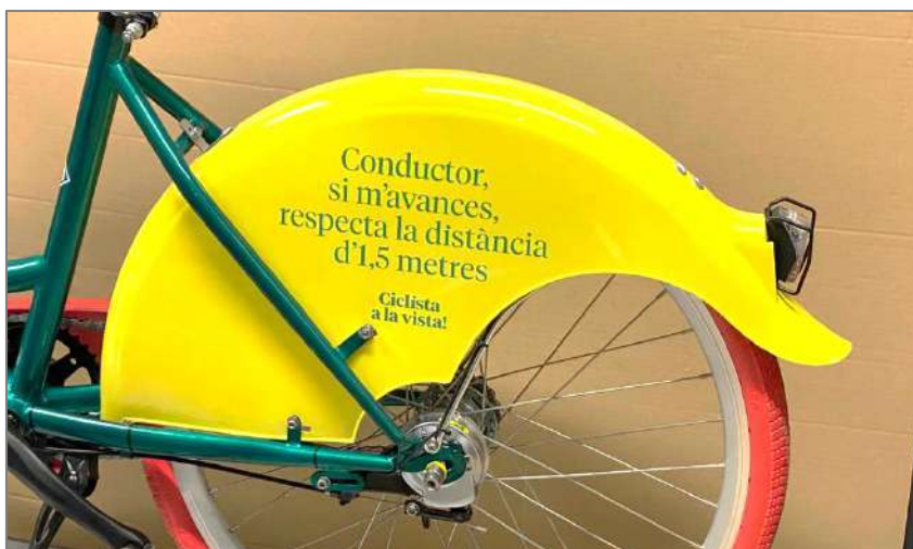
Imatge 05: Conjunt d'elements: parafangs posterior amb vareta de suport, elements de subjecció i llum posterior cablejada.
