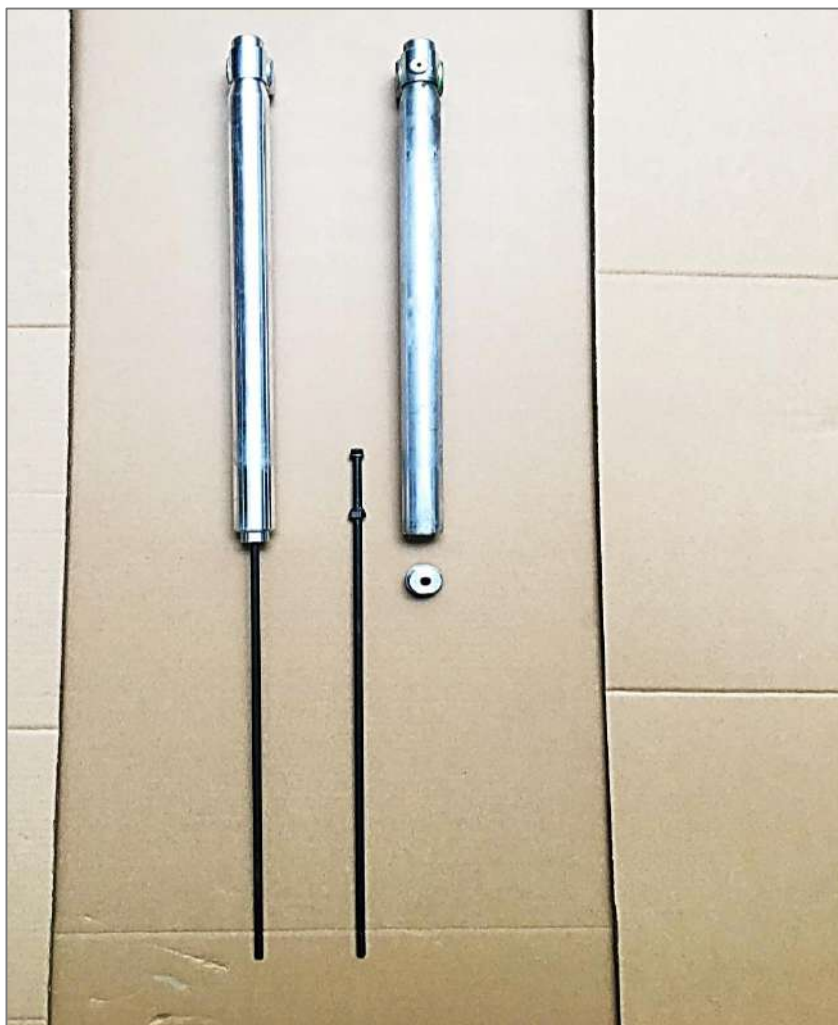
Imatge codi BICI039: Conjunt d'elements sistema anti-extracció
