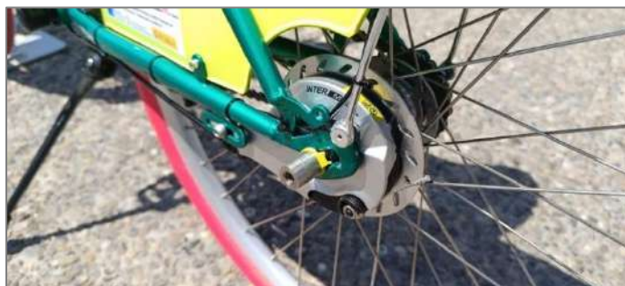
Imatge 13: Conjunt d'elements: Elements de l'eix posterior de la Girocleta protegits per femella anti-vandalisme.
