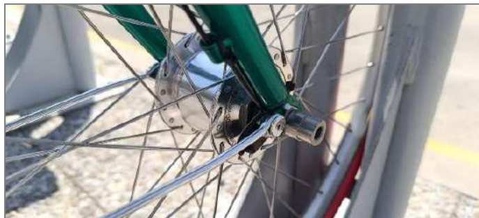
Imatge 12: Conjunt d'elements: Elements de l'eix davanter de la Girocleta protegits per femella anti-vandalisme.
