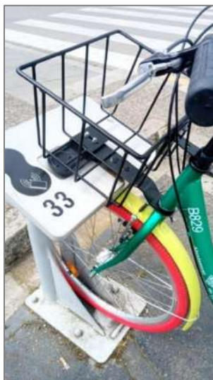
Imatge 03: Conjunt d'elements: forquilla, cistella i sistema d'ancoratge de Girocleta
