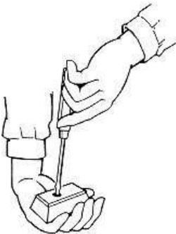
Fig. 14: Sujeción incorrecta de una pieza a atornillar
