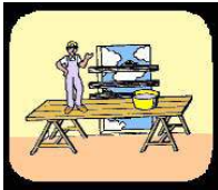
Fig. 16: Andamio situado junto abertura en pared protegida
