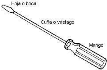
Fig. 11: Partes de un destornillador
