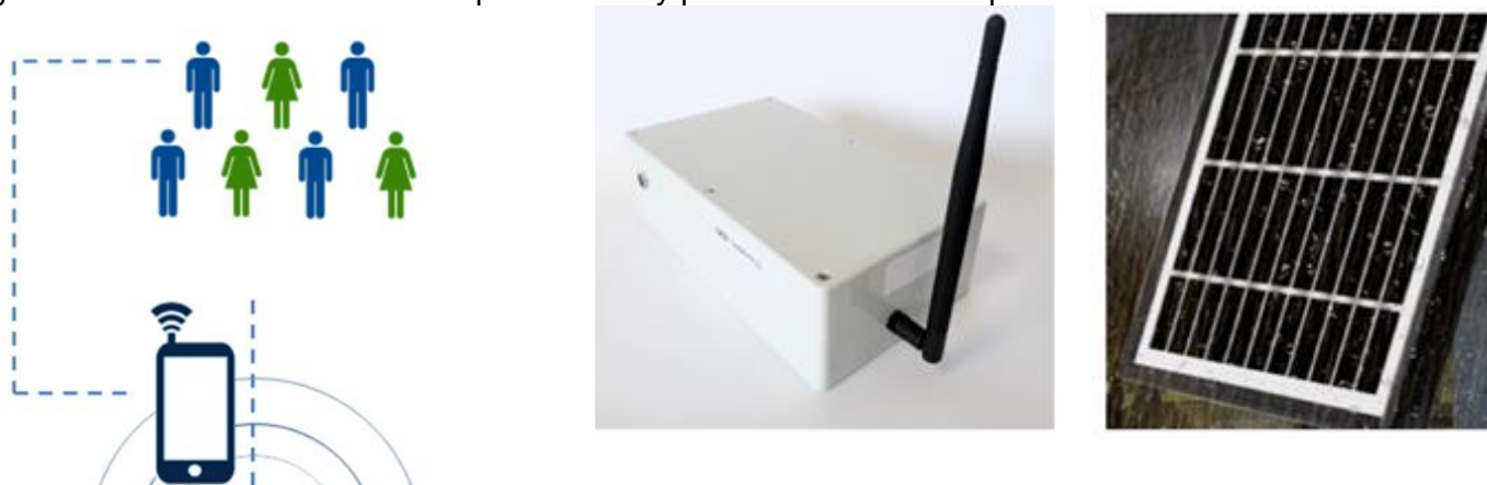
Figura. Sensor de aforo alimentado por baterías y placas solares. Presupuesto llave en mano
