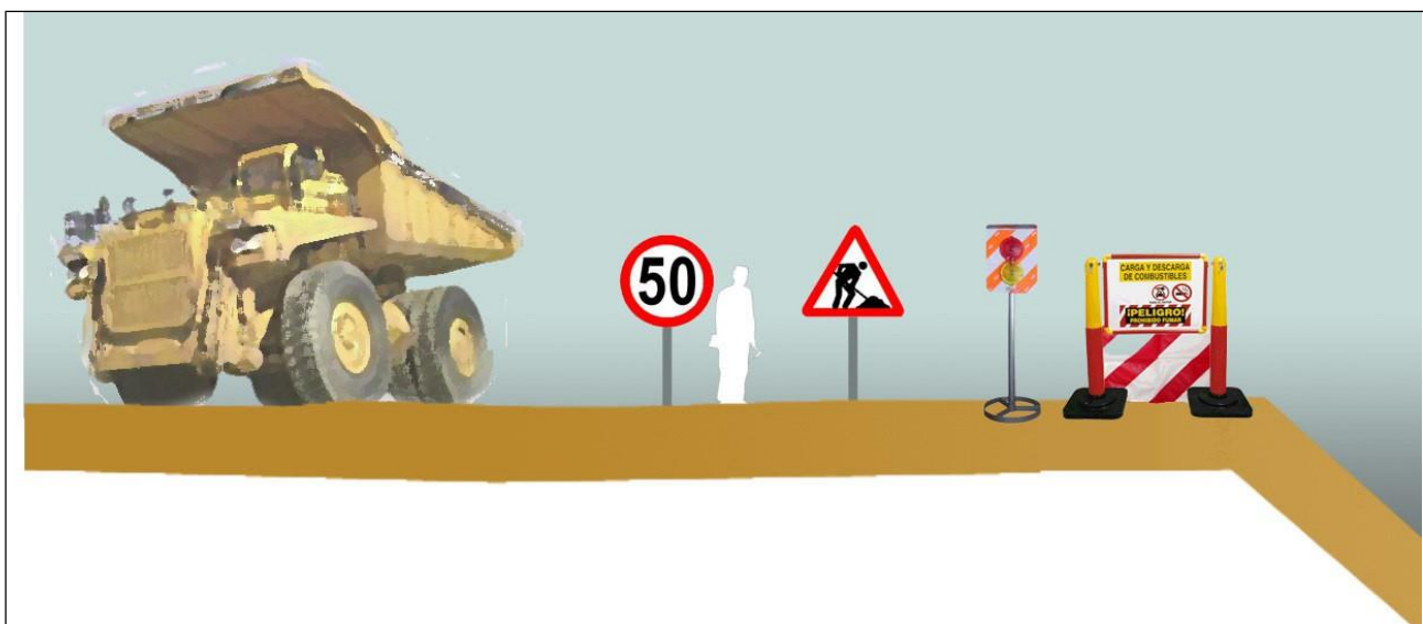
Esquema protecció i senyalització de desmunt i terraplens
