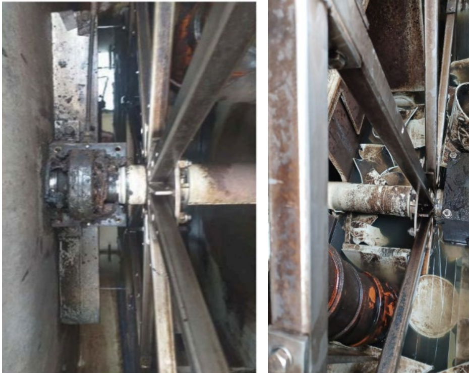
Imatge 11. Fotografia del 2022, del rodament malmès, s'observa un possible rascat de l'eix
