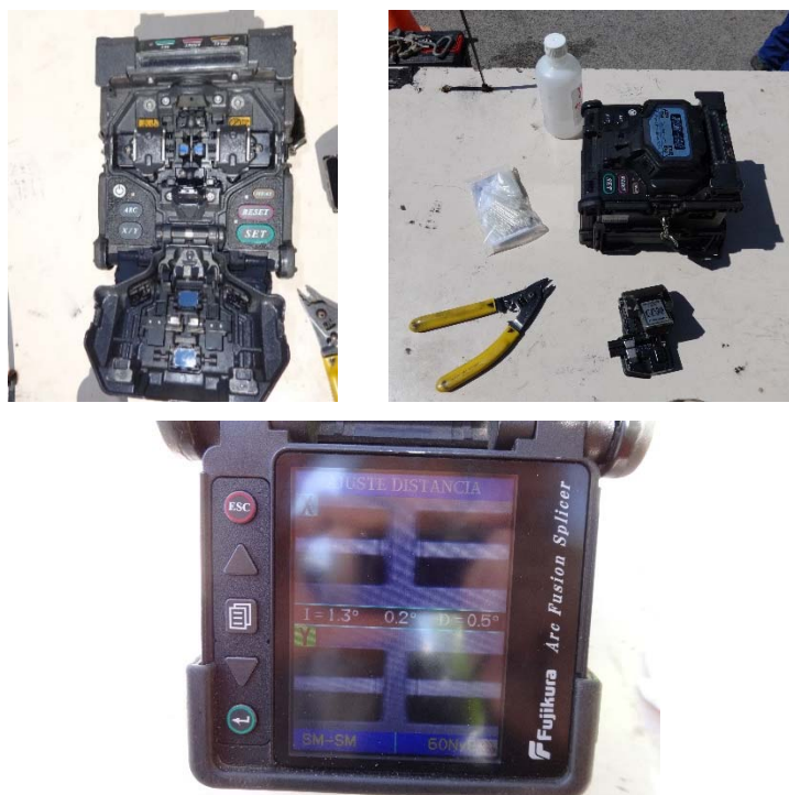
Detalls de maquinària de fusió, accessoris i arc voltàic en execució.
