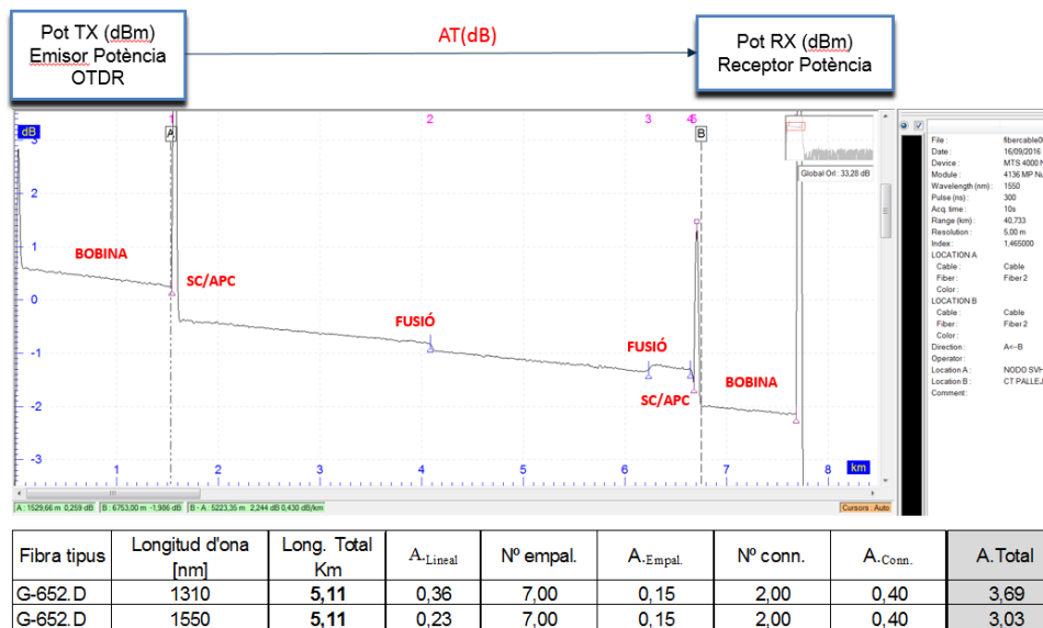
Exemple de mesures òptiques (gràfica reflectometria i taula de potències i atenuacions permeses).
