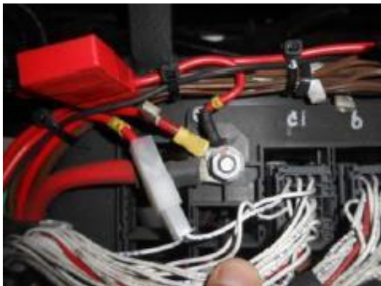
Figura 6: Detalle de instalación de un fusible aéreo.
