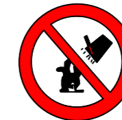
PROHIBIT APAGAR AMB AIGUA
