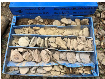
Fotografia 2: Materials recuperats de 0,00 a 3,00 m.
