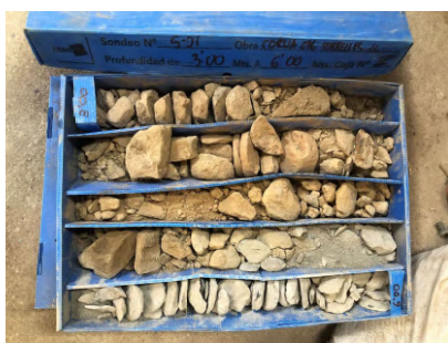
Fotografia 3: Materials recuperats de 3,00 a 6,00 m.
