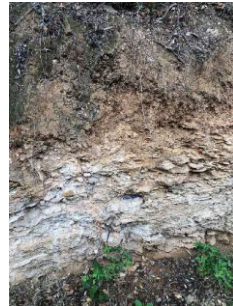
Fotografia 2: Vista dels materials del talús del carrer de Can Cartró. Més foliat.
