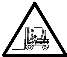
PASO DE CARRETILLAS
