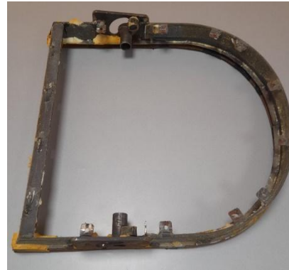
Estructura interior metàl·lica seient
