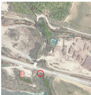
PK+740 hi ha un encreuament amb un torrent innominat. Encerclat l'encreuament amb el camí.
