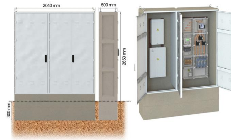
Figura 6 Model d'armari de formigó prefabricat amb la instal·lació d'enllaç (CGP+CS+TMF1) al seu interior
