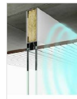
DETALLS MAMPARA mòdul tècni i barrera fònica
