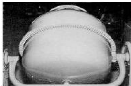
Corona y engranaje de rotación de la hormigonera sin protección
