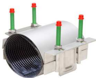
ABRAZADERA DE REPARACIÓN AVK, TIPO FS20 Placa de soporte, AISI 304, junta NBR, placa puente vulcanizada
