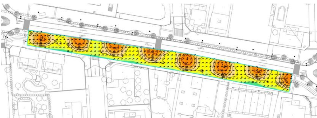
Figura 39. Dades de luminància en Vorera Sud Av. Barcelona.
